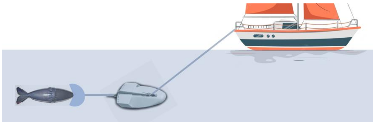
Abb. 6: Der Wal-PAL wird hinter dem Boot an einer 10m langen Edelstahlleine mittels Paravan in 2-3 m Wassertiefe geschleppt. So versperrt er den Orcas den freien Zugriff auf das Ruder
