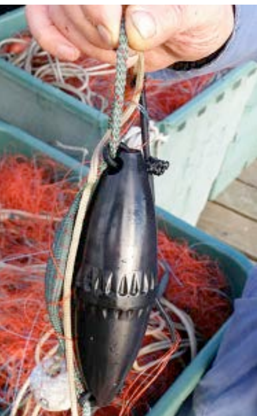
Rechts: Ein Forscher rettet einen Schweinswal, der sich in einem Fischernetz in Kanada verfangen hat. Links: Das PAL-Gerät des Kieler Schweinswal-Experten Boris Culik warnt die Tiere mit charakteristischen Klicklauten vor den Netzen.
